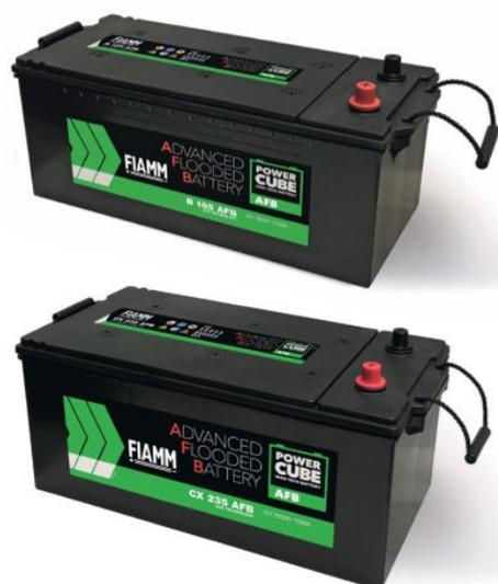
al piombo acido per applicazioni automotive, ma sono anche progettate con innovazioni volte a migliorare la sicurezza e la durabilità. Ne è un esempio il coperchio piatto ("flat") con labirinto interno, che equipaggia le batterie dei gruppi dimensionali A, B e C, pensato per trattenere e ricondensare i gas prodotti durante la carica, riducendo il rischio di fuoriuscite dell'elettrolita e migliorando la sicurezza con un sistema antiesplorazione.
