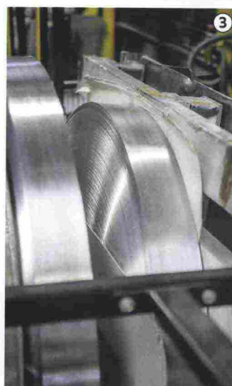
I lingotti di piombo (1) sono fusi, colati (2) e rettificati per ottenere enormi bobine di strip (3), positivo o negativo a seconda della lega utilizzata. Il nastro è inciso e aperto a diamante per arrivare a una griglia di varie dimensioni (4). Nel frattempo, il piombo (questa volta puro) è ridotto in cilindretti (5), dai quali, per attrito, in appositi mulini, si ricava l'ossido. Quest'ultimo, impastato con acqua e acido solforico, dopo debita stagionatura, darà vita alla massa attiva da spalmare sulle piastre ottenute dalla griglia
