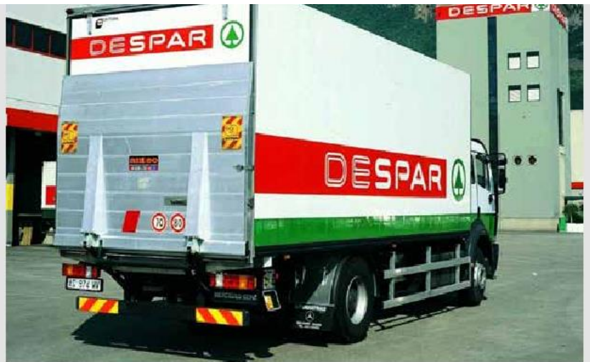
Le sponde caricatrici sono gli accessori che più gravano sulle capacità di ciclaggio delle batterie. Bisogna allora ricorrere a prodotti di livello elevato.
